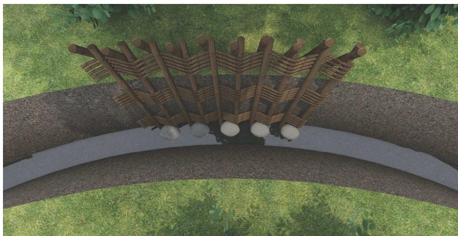
Riešenie je jednoduchšie a vhodné pre menej zaťažované brehy s postačujúcimi nosnými drevenými prvkami do priemeru 100mm prepájanými len prútenými výpletmi z miestne dostupného materiálu. Obdobne je na dno vhodné vloženie kamenného protierózneho pásu.
